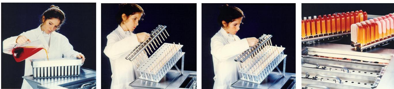
1. Dispositivo para el alineado de los palitos. Colocación en el extractor porta-palitos.
