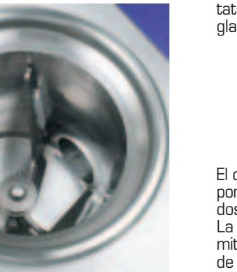
Der Vertikalzylinder macht die Einfüllung aller Zutaten von oben leichter. Der durchsichtige Deckel lässt andauernd das Verarbeitungsverfahren zu beobachten. Das Dreiarmrührwerk röhrt und schabt wirksam dank den Abschabmessern aus Teflon. Die Rührwerksgestalt garantiert den Mindesteisrest an den Wänden.
