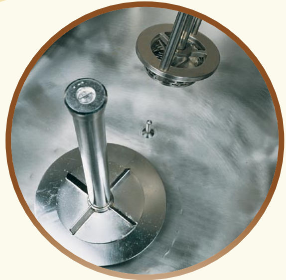
Micronizzatore ad alta velocità per miscele di gelato artigianale High speed micronizer for artisan ice cream mix
