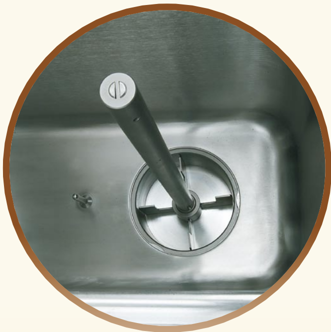
Pompa di travaso miscela e sonda rilevamento temperature in vasca Mix transfert pump and temperature probe inside the vat
