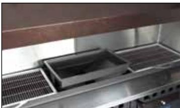
La plancha está sostenida en un marco de estructura deflectora que tiene la tarea de recoger la ceniza y colocarla en el cajetín inferior de recogida. El marco es extraíble para su limpieza y acceso a la parte inferior. Mediante unas palancas se puede regular la altura.
