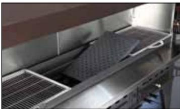
Cada pozo está constituido por una plancha perforada en acero térmico, para apoyar a las brasas y mantener el calor, ahorrando combustible. Los orificios dejan caer las cenizas y la base es extraíble para conseguir la limpieza y un cómodo acceso a la parte inferior.
