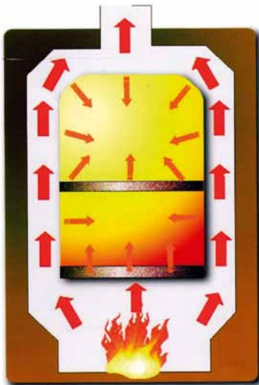
humos de combustión pasan a través de un interespacio lateral. Durante el recorrido dan calor a la cámara la cual calienta **uniformemente** toda la superficie. Los dos planos refractarios se calientan indirectamente por las llamas. Este sistema evita que la comida esté en contacto con los humos de combustión y con las cenizas, evitando así **contaminación alimentaria**: con ello los hornos PEVA cumplen la normativa Europea.
