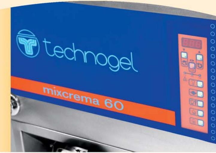
Los **Mixcrema 30 y 60** de la línea Technogel son máquinas completamente automáticas para la producción de las cremas pasteleras, chocolates templados, bases de helados, mermeladas como también bases para turrones. Construidas totalmente en acero inoxidable, con todos sus componentes desmontables para una mejor limpieza, están compuestas de las siguientes partes:
