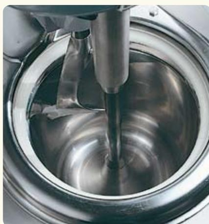
Vasca in acciaio inossidabile con sistema di raffreddamento trasmesso da un liquido diatermico.
