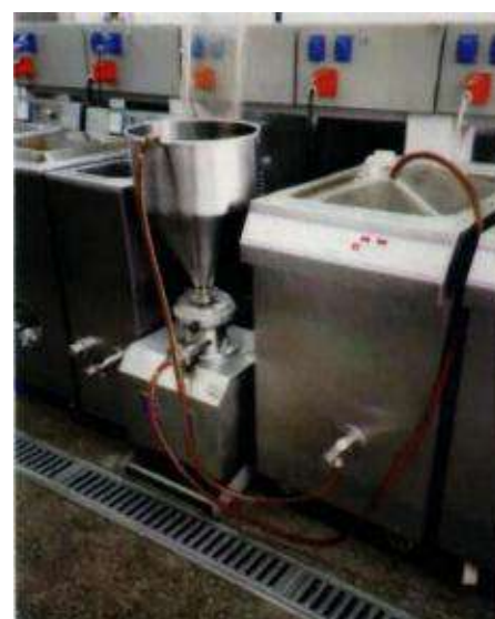
Modelo MC 100 TR homogeneizando en línea con un pasteurizador dotado de bomba
