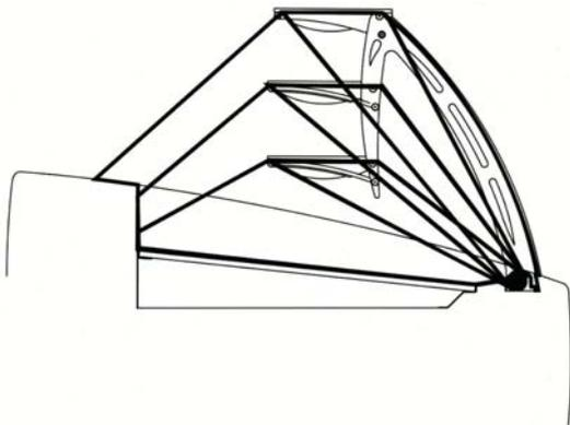
Innovador sistema de iluminación mediante la luz reflejada (Sistema patentado)
