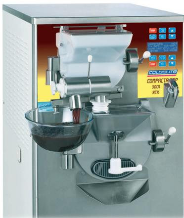
Trabajar en caliente, sirviéndose sólo del cilindro superior, por ejemplo para la cocción de un producto que se debe llevar a ebullición, extrayéndolo por la salida lateral del grifo externo, sin utilizar el cilindro inferior, que se puede utilizar para otra elaboración.
