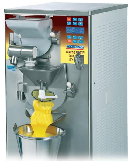
Trabajar en progresión, cilindro superior + cilindro inferior, iniciando por ejemplo la cocción de un producto en el cilindro superior, pasándolo a través del grifo externo directamente al cilindro inferior, para enfriarlo y congelarlo.
