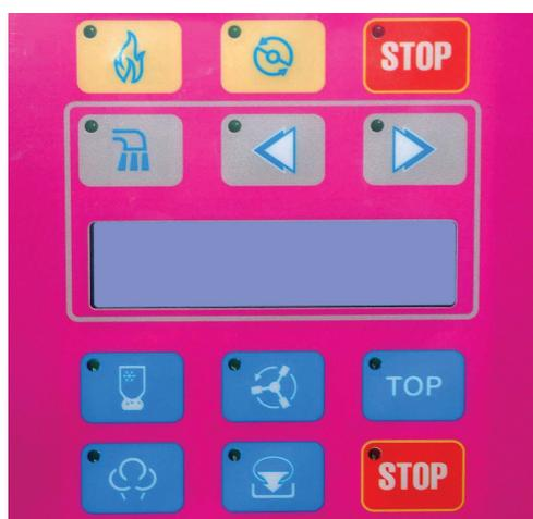
Pasteurizador. El interruptor de mando tienen iconos de fácil interpretación; pulsando la tecla calefacción se sube el ciclo a 85°C, que puede ser modificada por el operador a voluntad. Una señal acústico/visual avisa cuando se ha alcanzado la temperatura programada. La mezcla acabada es trasvasada al cilindro de mantecación, por el grifo externo, para ser velozmente refrigerada y transformada en helado. El grifo de acero, con colector de introducción, es fácilmente desmontable y lavable.
