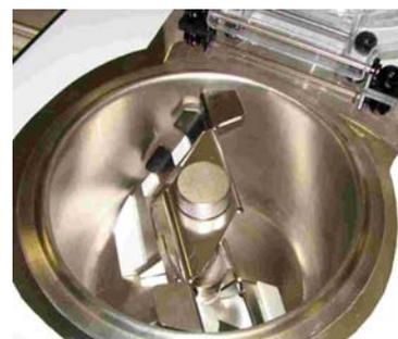
Agitador con lama raspante de polietileno (PE) de larga duración
